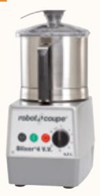
Permet la réalisation de tous les mixés crus ou cuits. Pour 10 à 50 couverts. Puissance : 1100 W - vitesse : 300 à 3000 tr/min. Cuve inox de 4,5 L avec racleur de cuve et couvercle. Capacité de travail de 0,3 à 2,5 kg par opération. Couvercle étanche. Couteau à lames micro-dentées.
