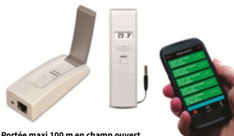
Portée maxi 100 m en champ ouvert. Composé d'une passerelle internet et 1 capteur pro. Permettant de suivre la température d'une chambre froide et de recevoir les alertes sur un smartphone. (accepte jusqu'à 50 capteurs). Piles non fournies.
