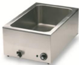
Bain-marie avec vidange (en façade). Cuve GN 1/1 pour bac gastro. Thermostat réglable de 0 à 70°C. Branchement par câble de 1 m. Thermostat de sécurité. Charge maxi : 20 kg. Chauffage par eau. 230 V monophasé, 50/60 Hz. Livré sans bac.
