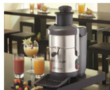
Débit : jusqu'à 120 L /h. Ejection de la pulpe dans un conteneur amovible, capacité 6,5 L. Hauteur utile sous bec verseur : 162 mm.
