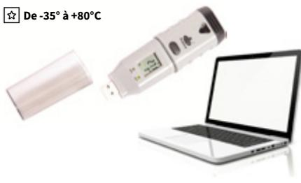
Suivi des températures dans les chambres froides, salles de conditionnement, caissons frigorifiques, etc. Enregistreur de température, avec port USB, écran, alarme visuelle haute et basse programmable, départ programmable, mémoire 16k. Précision : ± 0,5°C, ± 5% sinon. Pile 3,6 V, 1,5 AA. Intervalle d'acquisition réglable de 10 secondes à 12 heures. Livré avec CD (1). Capacité : 32 000 mesures.
