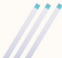
A utiliser dans de l'huile froide. Permet de tester le vieillissement de l'huile conformément à la réglementation.
