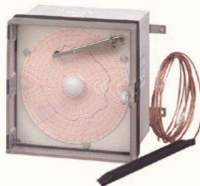
Enregistreur mécanique à diagramme pour le contrôle des températures en chambre froide positive ou négative de -40° à +40°C. Capacité 7 jours d'enregistrement. Face avant étanche IP64. Sonde avec fil L 3m. Livré avec un paquet de 100 disques, 1 plume et 1 pile LR06. Dimensions : 140 x 140 x 110 mm, poids 680g. Plume : 20 x H10 mm.
