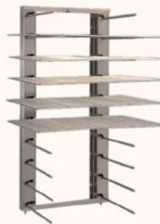
En acier inoxydable. Profondeur échelle pliée : 50 mm. 10 niveaux espacés de 90 mm. Charge maxi par niveau : 10 kg. Verrouillage des bras dans les 2 positions ouvert / fermé. Compatible plaques ou grilles 600 x 400 et GN 1/1. Visserie inox fournie pour la fixation murale.
