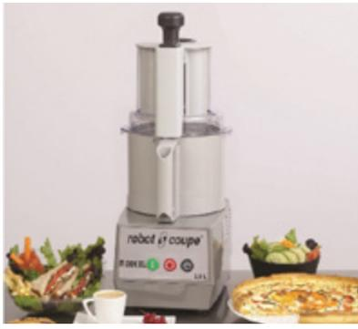
Permet de réaliser le travail des viandes, légumes, farces fines, mousses. Broyage, pétrissage en moins de 5 mn pour les opérations les + longues. Puissance : 550 W - 1 vitesse : 1500 tr/min. Cuve cutter de 2,9 L en ABS et couteau lisse fond de cuve inclus. Appareil livré avec 2 disques : éminceur 2 mm et râpe 2 mm. Collection de 23 disques disponible. Convient pour 10 à 20 couverts.
